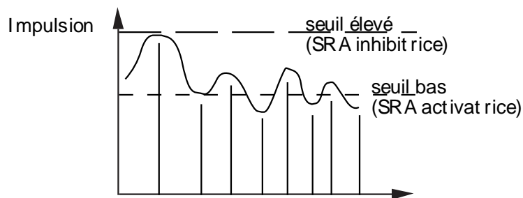
Figure 21 : Niveau de seuil et niveau d'activité
